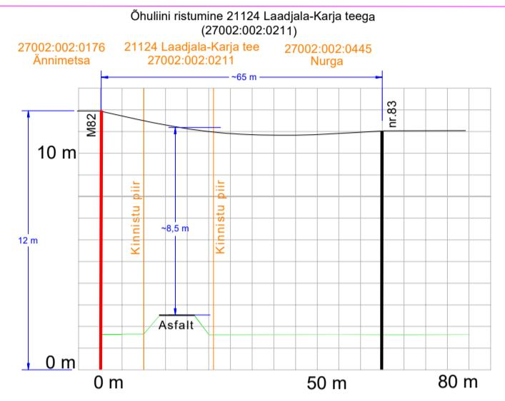
Rekonstrueerida PAHI 10 kV Fiidril öhuliinilök mastist M58 - M82 Paljasjuhe asendada isoleeritud öhuliini juhtmega BLL99, L=1820 m (trass).
